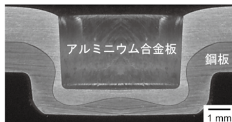
図4 アルミニウム合金板と高張力鋼板のクリンチング接合。(異種板材の接合性を改善し、利用促進に貢献します。)
