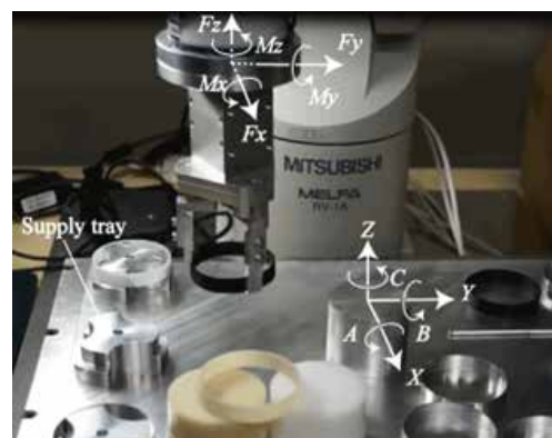
図4 受動調芯原理による自動組み立ての実機検証
