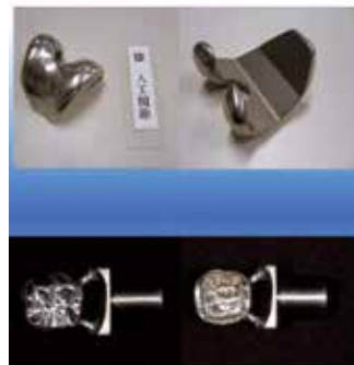
MDF純チタン製の人工関節と歯科クラウンの試作サンプル例 (神奈川歯科大・木本先生、星先生作製)
